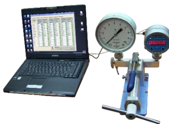
1.2 - сурет – Өлшеу жүйелері - өлшеу құралдарын тексеру мысалы
